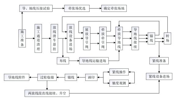
图 3.1-4 架线施工流程图
