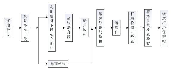
图 3.1-4 铁塔安装流程图
