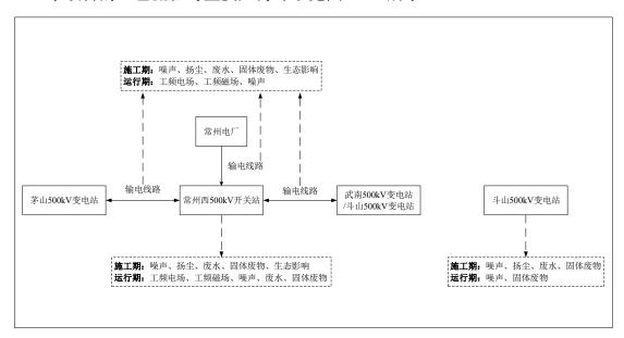
图 3.3-1 本项目工艺流程与主要产污环节示意图
