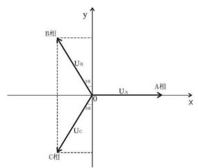
图 6.1-7 对地电压计算图
