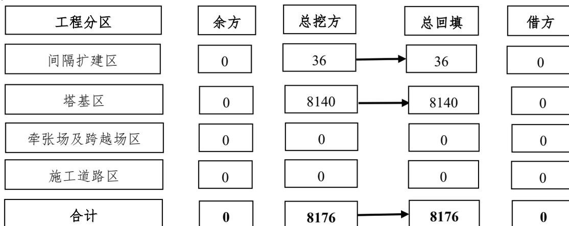
图 1.1-5 土石方平衡流向框图 单位: m<sup>3</sup>表 1.1-8 表土平衡一览表 单位: m<sup>3</sup>
