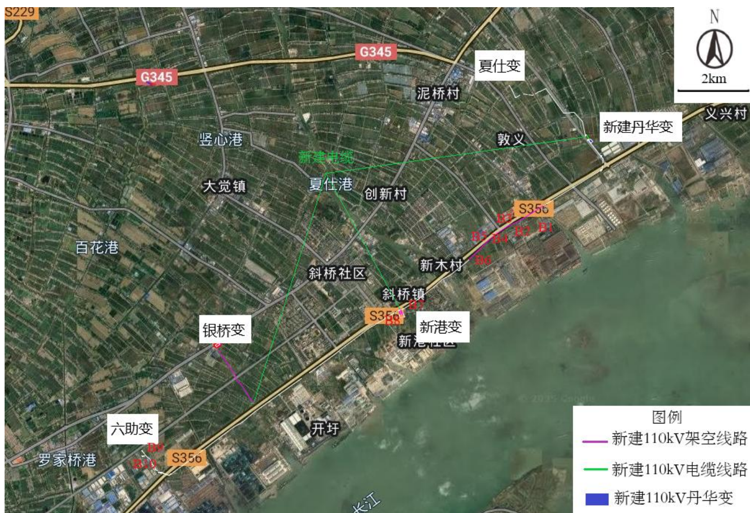
图 1.1-2 江苏泰州丹华 110 千伏输变电工程路径示意图
